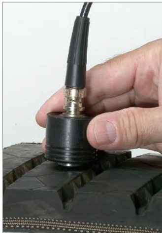
Измерение глубины залегания стального/плетеного кабеля в резиновых конвейерных лентах и автомобильных покрышках.
