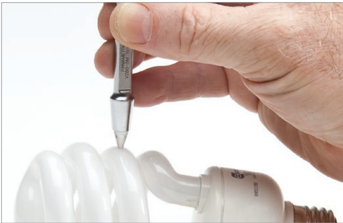
Измерение тонкого стекла с помощью преобразователя V260-SM Sonopen®
