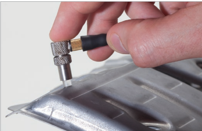
Измерение утонения металла после формования.
