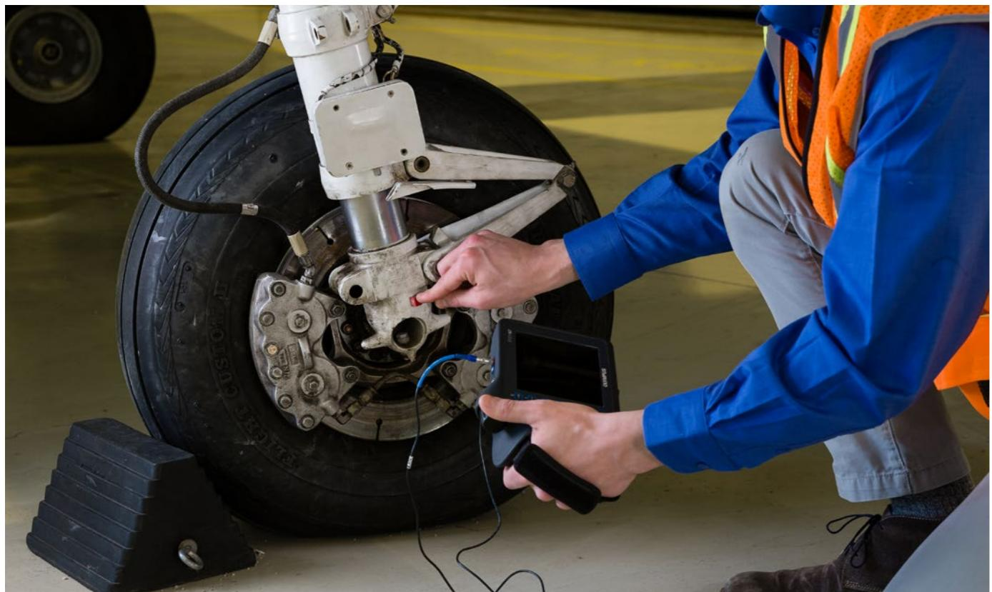
**Оптимизирован для работы одной рукой:** Аппаратное и программное обеспечение позволяет максимально эффективно управлять прибором одной рукой, освобождая вторую руку для позиционирования преобразователя
