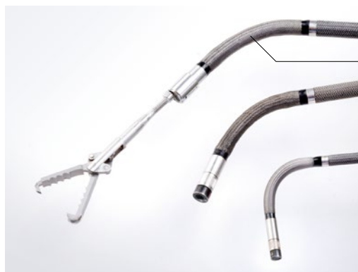
Зонд с внутренним рабочим каналом и инструментом для извлечения посторонних предметов
